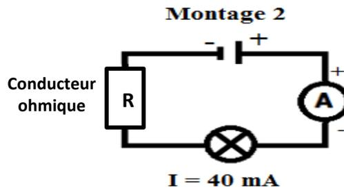
❖ **Remarque** : Plus la résistance présente dans un circuit est élevée plus l'intensité du courant électrique est faible.
